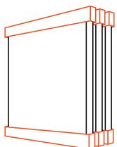
**POSICIONAMENTO CORRETO DOS COLETORES PARA TRANSPORTE E ARMAZENAMENTO**
